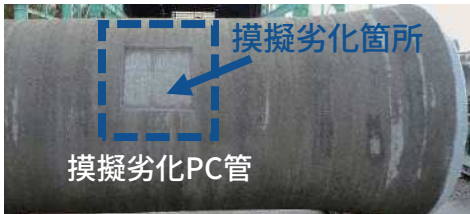
劣化を模擬したPC管による 適用性検証実験
