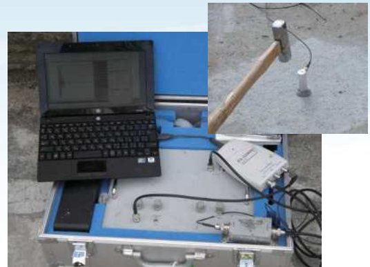
調査装置の構成 (装置本体、受信センサ、鋼製ハンマー)
