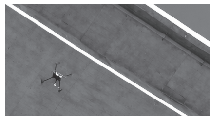
写真-1 PC箱桁の自動飛行撮影の状況
