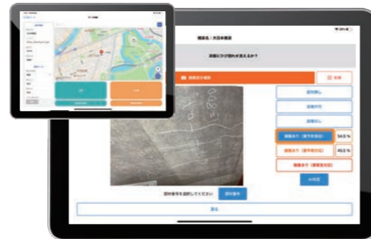
AI橋守ヘルパーの画面(左上:橋梁位置表示,右下:損傷判定画面)
