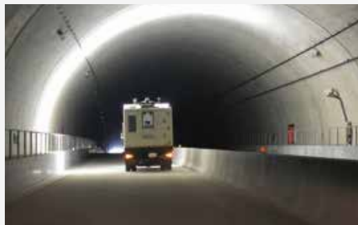
走行型画像とレーザー計測による点検支援技術を活用
